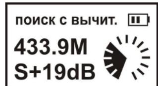
В режиме поиска с вычитанием спектра реализована световая и звуковая индикация относительного уровня сигнала – по частоте повторения вспышек светодиода можно судить о приближении или удалении от радиопередатчика.
