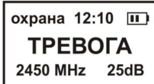
Следующий звуковой сигнал тревоги появляется не ранее чем через пять минут и только для нового опасного сигнала. Вибросигнал при состоянии тревоги повторяется каждые пять минут. Кроме того, текущее состояние можно определить по частоте мигания светодиода: редкое мигание – норма, частое – тревога.
